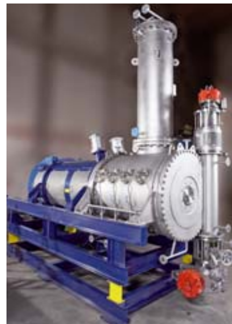
Die neue Generation der KneaderReactor-Technologie beherrscht unter anderem radikalische Polymerisationen
