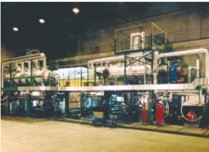
1: Trocknungsanlage für Chargen- oder kontinuierlichen Betrieb
